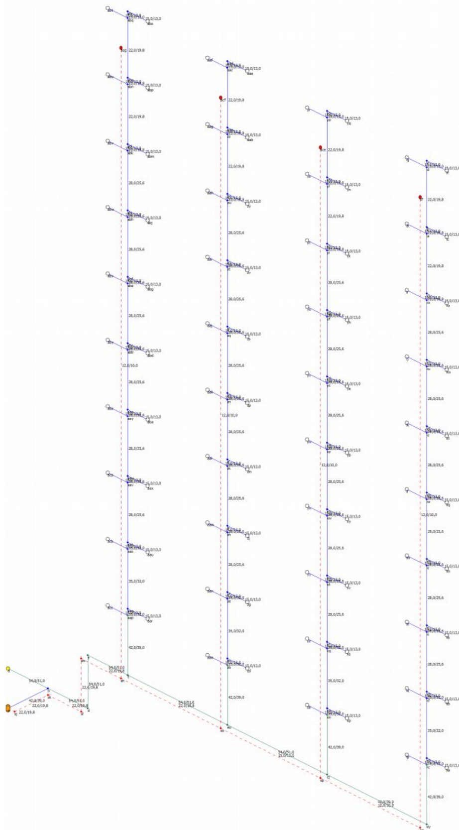
Figuur 9: Leidinglayout referentiesysteem 1, lange deelringcirculatieleidingen met een laag gelegen circulatieverzamelleiding.
